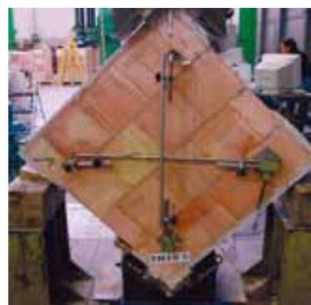
5. Prove di compressione diagonale: test set-up.
