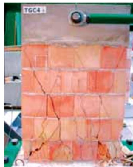
10. Diagramma carico laterale-spostamento sotto un carico verticale pari al 27% della massima resistenza a compressione (in alto); stato fessurativo al termine della prova (in basso).
