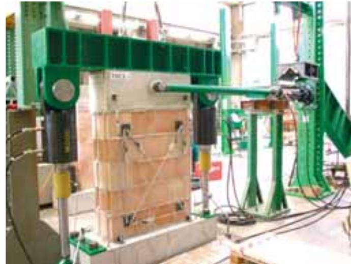
8. Prova di compressione e taglio: test set-up.
