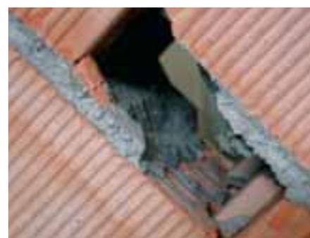
6. Collasso con rottura di un blocco lungo la direttrice di carico (*in alto*, campione di tipo Po) e rottura del giunto ordinario e dei relativi denti di malta (*in basso*, campione di tipo TG).
