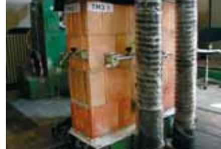
3. Prove di compressione monoassiale: configurazione di prova.
